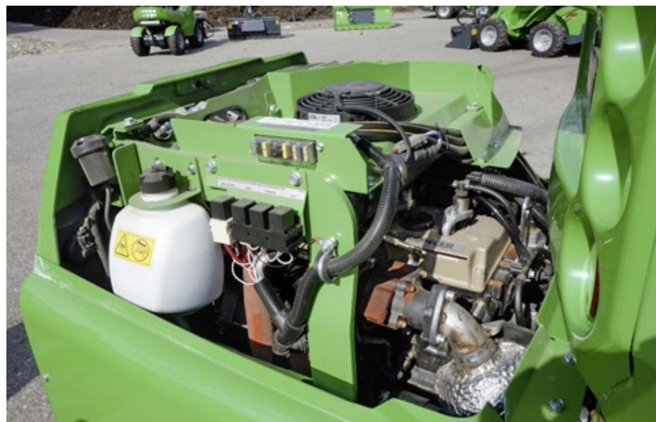
Der Kohler-Motor, welcher im Modell 760i serienmässig eingebaut ist, erfüllt die Tier-4-Final- und die Stage-IIIB-Abgasnormen und braucht keinen Russpartikelfilter.
